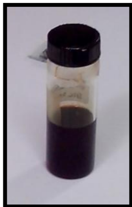
Figura 3.20 Solución electrolítica I^-/I_3^- .
