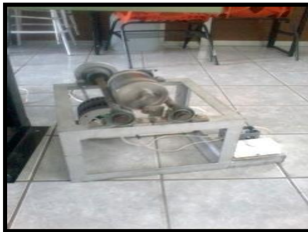
Figura 3.12 Molino de acero inoxidable con balines en el interior.
