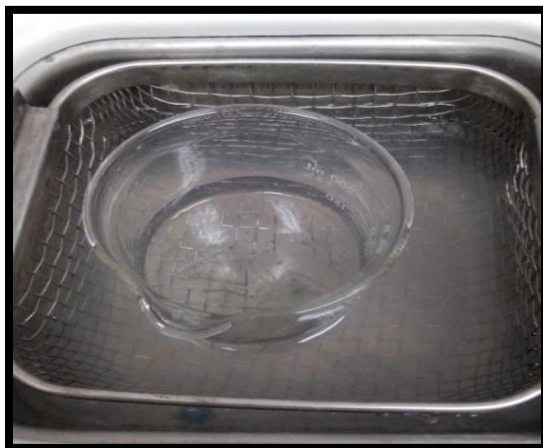
Figura 3.21 Piezas de surlyn en el baño ultrasónico.
