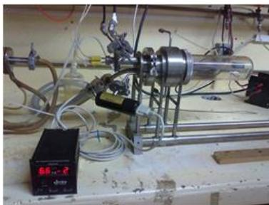
Figura 3.18.- Dispositivo para depósito de CdTe
