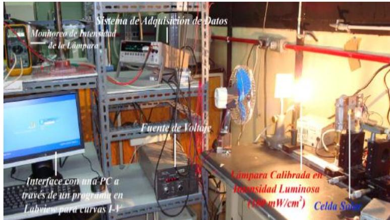
Figura 3.11.- Sistema de medición de la característica I-V
