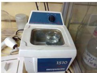
Figura 3.13.- Sustrato de vidrio en baño ultrasónico
