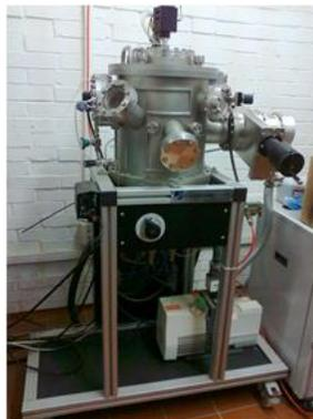
Figura 3.16.- magnetron Sputtering (CIE-UNAM)
