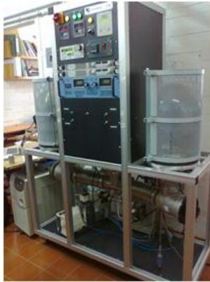
Figura 3.22.- Evaporadora (CIE-UNAM)
