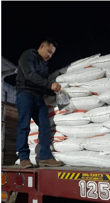
Fig. 5. Toma de muestra de 250 gramos de fertilizante antes de la descarga.
