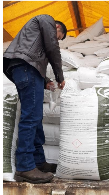
Fig. 5. Toma de muestra de 250 gramos de fertilizante antes de la descarga.
