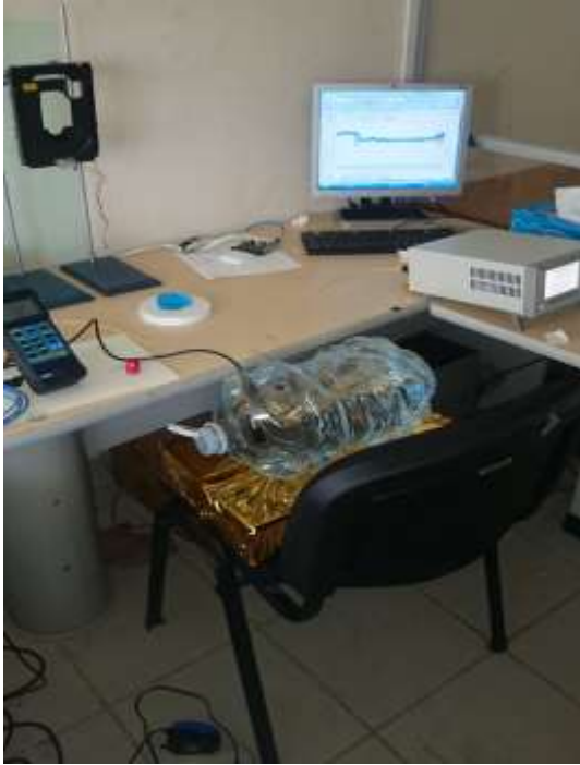
Figura IV. 17 Arreglo experimental para caracterizar agua de llave con el sensor y un oxímetro.
