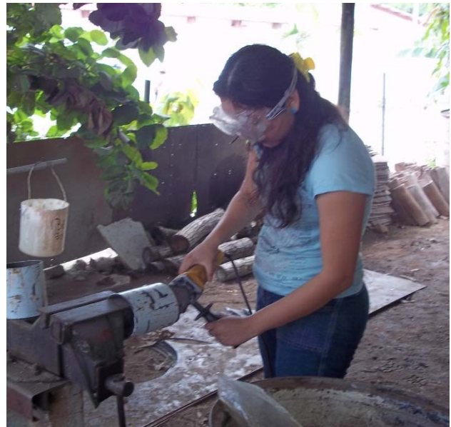
Fig. 4.15. Construcción del tubo de entrada de la estufa Lekil Vaj. Corte y esmerilado. Fotos Neín Farrera.
