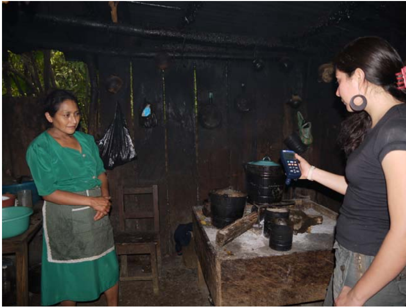
Fig.4.6. Medición de la concentración de CO dentro de las viviendas. Comunidad Tierra Blanca, Chiapas.
