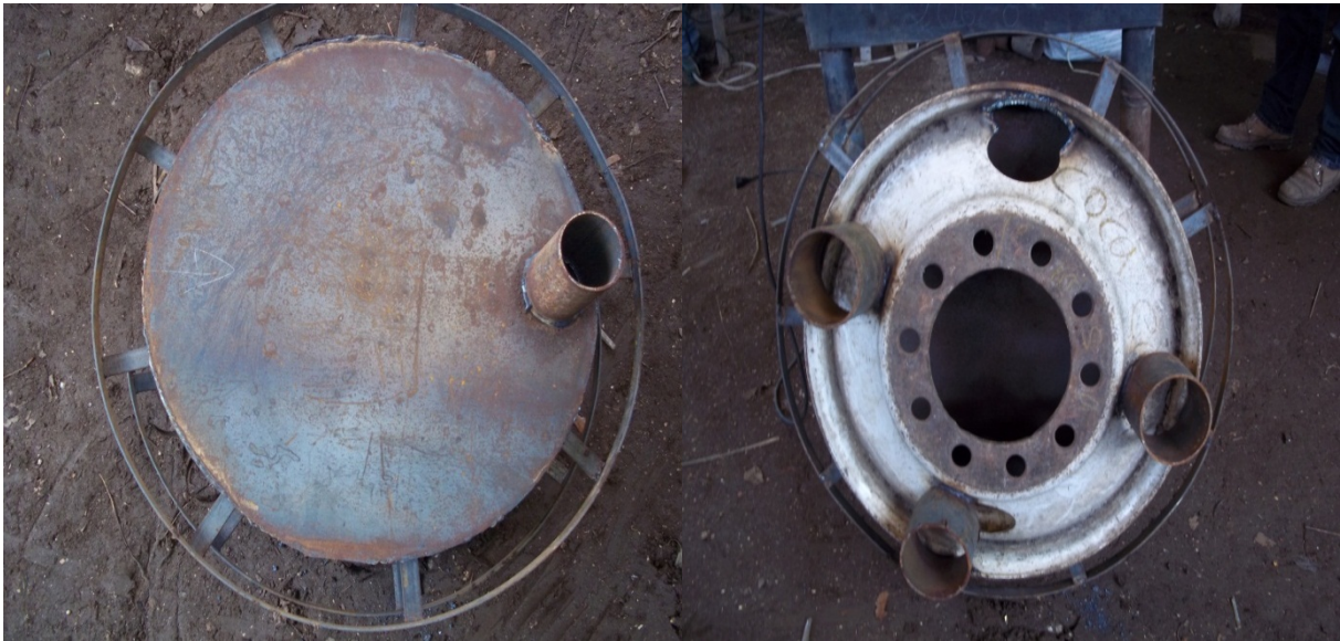
Fig. 4.16. Vistas de la cámara de combustión, a) Superior, b) Inferior
