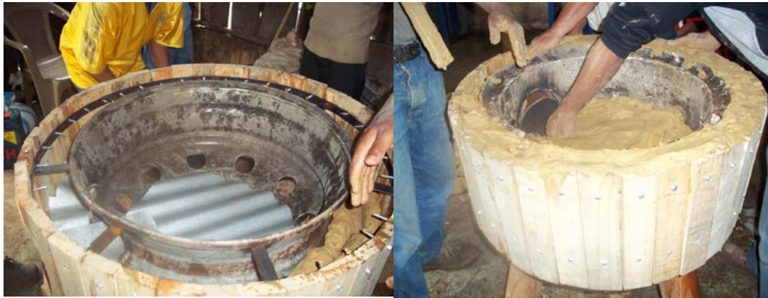
Fig.4.24. Preparación de las estufas en cada vivienda. Fotos Pascual López
