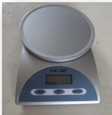
**Figura 4.39.** Balanza digital, con esta se determinó y registro la variación de la masa de las muestras de queso.
