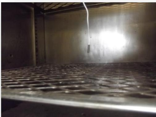
**Figura 4.40.** Sensor de temperatura y humedad.
