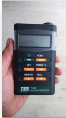
**Figura 4.43.** Solarímetro usado para medir la radiación solar.
