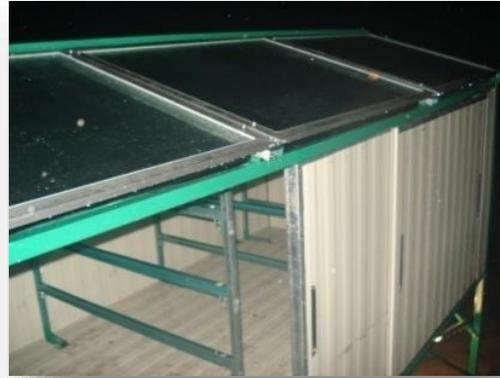
**Figura 4.15.** Cámara de secado y colectores solares de aire instalados.
