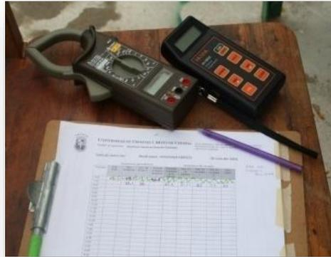
**Figura 4.19.** Termo higrómetro, y multímetro usados.
