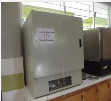
**Figura 4.22.** Estufa eléctrica de laboratorio, dispositivo de secado para las pruebas bajo condiciones constantes.
