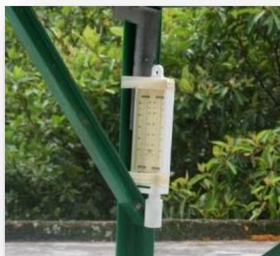
**Figura 4.17.** Termómetro de bulbo seco y de bulbo húmedo.
