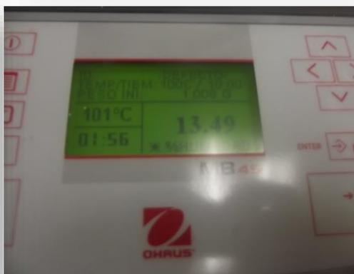
**Figura 4.38.** Termo balanza usada para determinar la humedad de las muestras.
