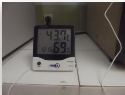
**Figura 4.41.** Termo higrómetro.
