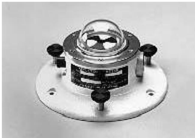
**Figura 3.2.** Esquema de un piranómetro.
