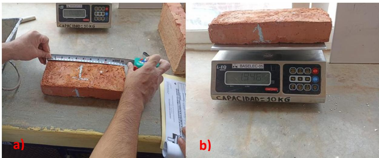
*Nota:* En la figura se aprecia a) la medición de los especímenes y b) determinación de la masa.
