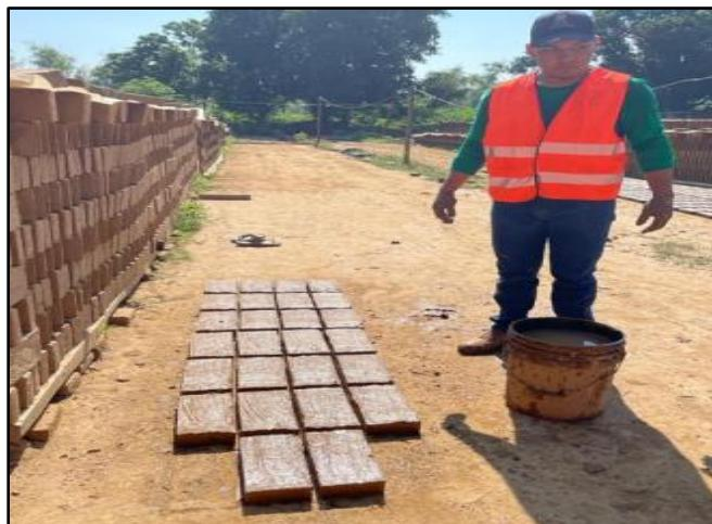
Estos 400 especímenes fueron fabricados de un mismo aditivo, mezcla y se manipularon por una única persona, posterior al proceso de fabricación los especímenes fueron evaluados en un laboratorio certificado de estudio de mecánica de suelos y resistencia de materiales “LabSur”.
