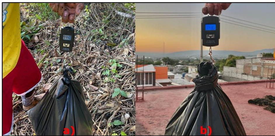
*Nota:* La imagen representa los dos procesos de pesado para la determinación de humedad del LA en donde se aprecia en a) Pesado en húmedo del LA, b) Pesado en seco del LA.
