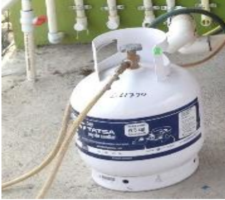
Figura 4.17. Tanque 1 biogás comprimido
