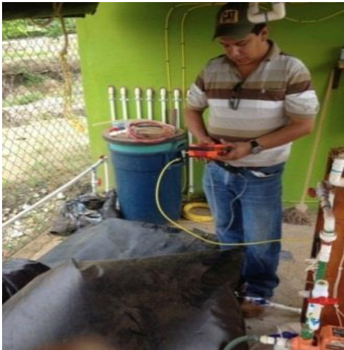
Figura 4.12. Toma de muestra con equipo multitec 540
