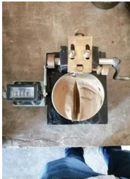
Figura 4: límites de atterberg realizados a las muestras de suelos obtenidas de los sondeos realizados en la col. 6 de junio, Tuxtla Gutiérrez, Chiapas.
