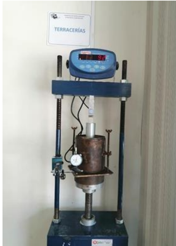
Figura 5: ensayo de VRS realizado a la muestra de suelo obtenida de los sondeos realizados en el terreno ubicado en la col. 6 de junio, Tuxtla Gutiérrez, Chiapas
