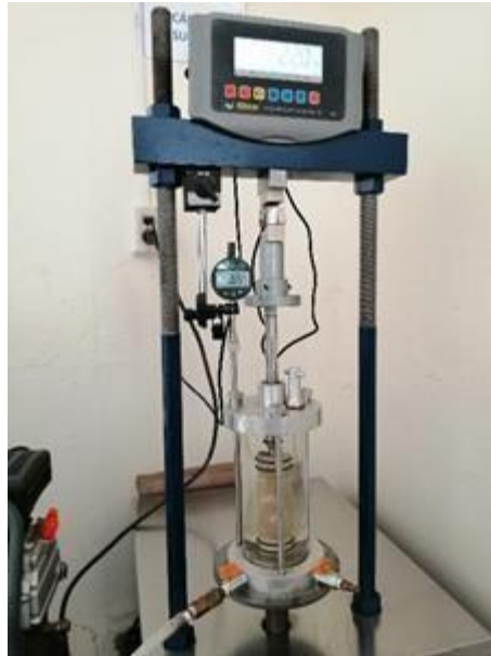
Figura 3: ensayos triaxiales realizados en las muestras de suelos obtenidas de los sondeos realizados en la col. 6 de junio, Tuxtla Gutiérrez, Chiapas
