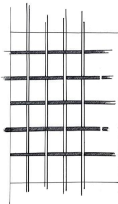
Figura 1. Dibujo de la trama de ligamento de tafetán
