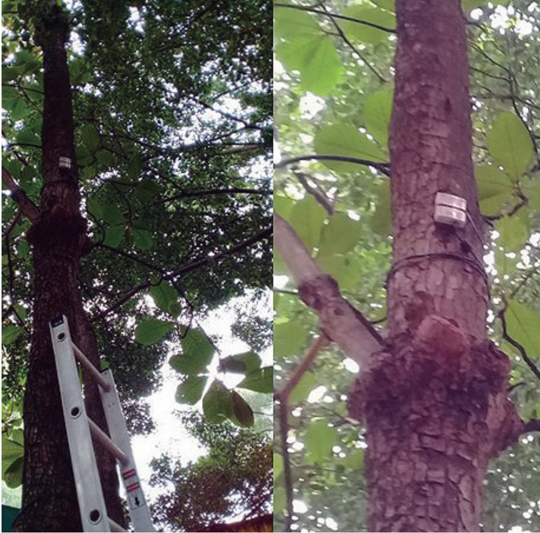
Figura 4. Equipo HOBO Data-Logger instalado en el Parque Caña Hueca
