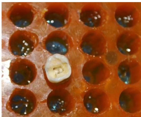
Imagen 11 Rejilla de plástico con gel para ultrasonido, sosteniendo un molar.
