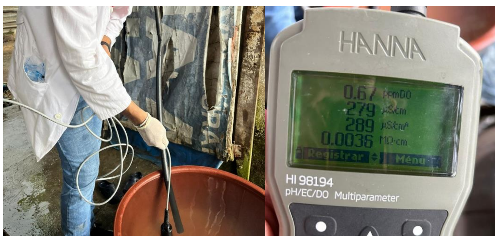
Figura 11. Medición In situ de parámetros físicos
