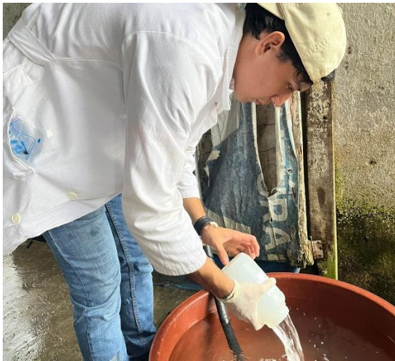
Figura 10. Triple lavado para los parámetros físicos y químicos.
