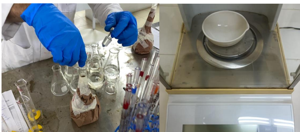
Figura 13. Medición de nitratos, nitritos y SDT.
