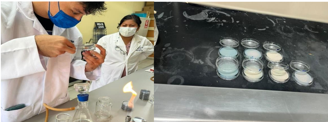
Figura 14. Medición de coliformes fecales y totales.
