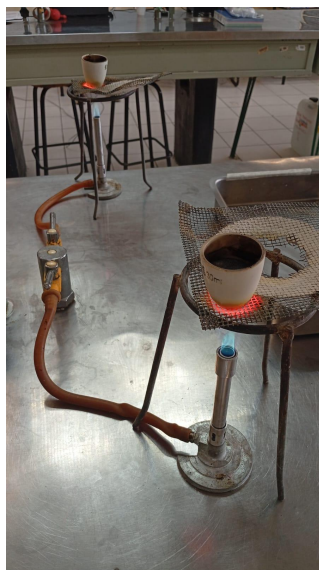
Figura 15. Determinación de humedad y cenizas (2025).
