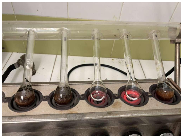
Figura 17. Determinación de proteína cruda por método de Kjeldahl (2025).
