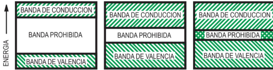
Figura 5. Esquema de bandas en aislantes, semiconductores y conductores respectivamente.
