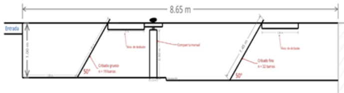
Figura 4. Planos del proceso de pretratamiento área de cribado y desbaste (Vista lateral y superior).
