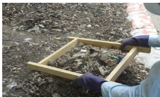
Figura 7. Cribado de los residuos estabilizados
