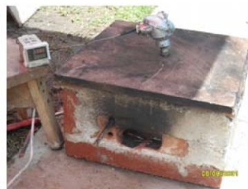
Figura 3. Recamara de ensayos térmicos
