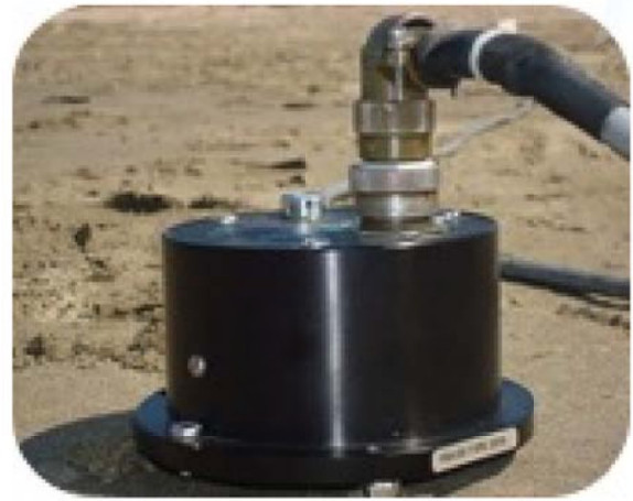
Imagen 2. Acelerómetro EpiSensor triaxial (canales este-oeste, norte-sur y vertical).
