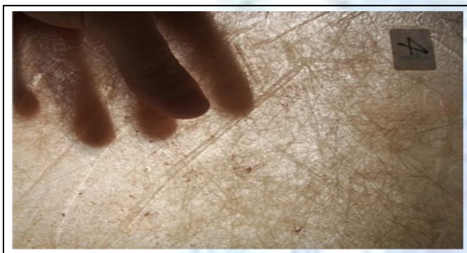
Figura 3. Material compuesto por cuatro estratos de fibra de vidrio Mat embebidos en matriz de poliéster insaturado.
