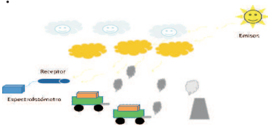
Figura 7. DOAS pasivo principales componentes, el sol es la fuente de luz y la parte inferior izquierda se ve el receptor y el espectrofotómetro.
