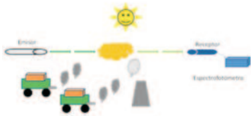
Figura 6. Principales componentes del DOAS activo.
