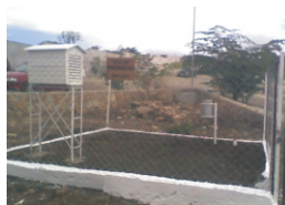
Figura 1. Estación termopluviométrica, de la facultad de ingeniería Ambiental de la Unicach.
