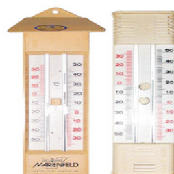
Fig. 3 Termómetro Six o también llamado de máxima y mínima
