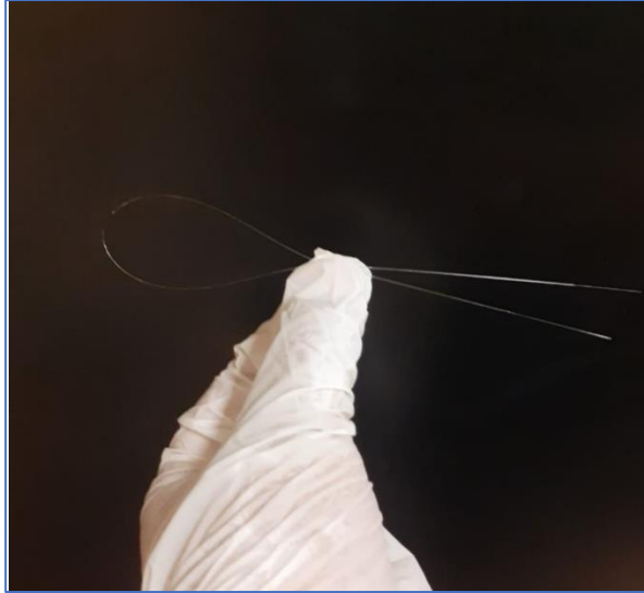
Figura 13. Eliminación del recubrimiento en la fibra óptica.
