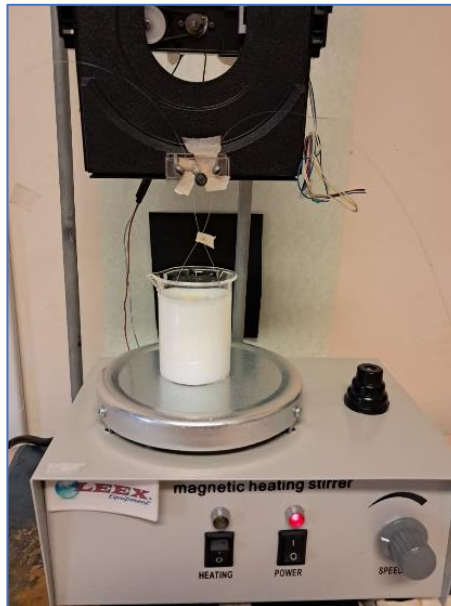
Figura 17. Prueba del biosensor con pesticida.
