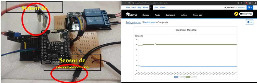
Figura 36. Sistema embebido e interfaz web. Fuente: Elaboración propia.
