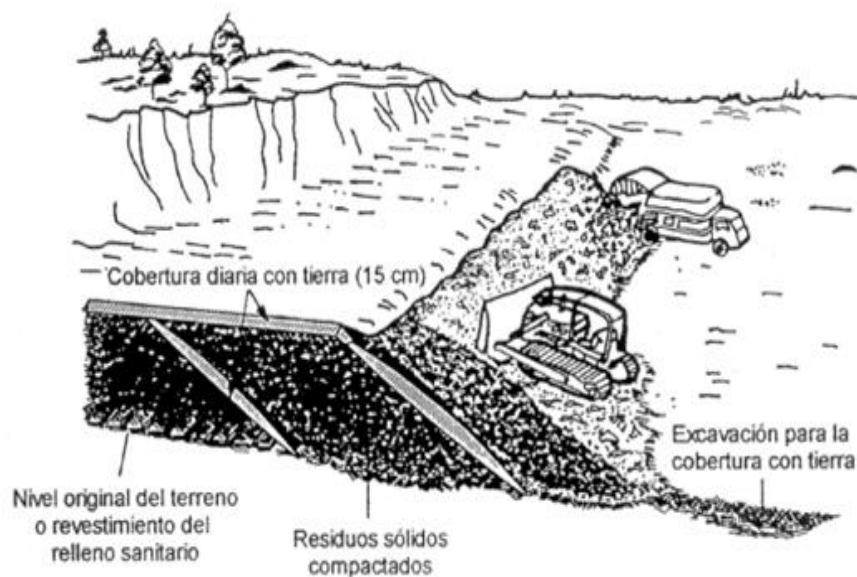
Figura 4 Relleno Sanitario Tipo Rampa. Fuente (Alegría, 2020)
