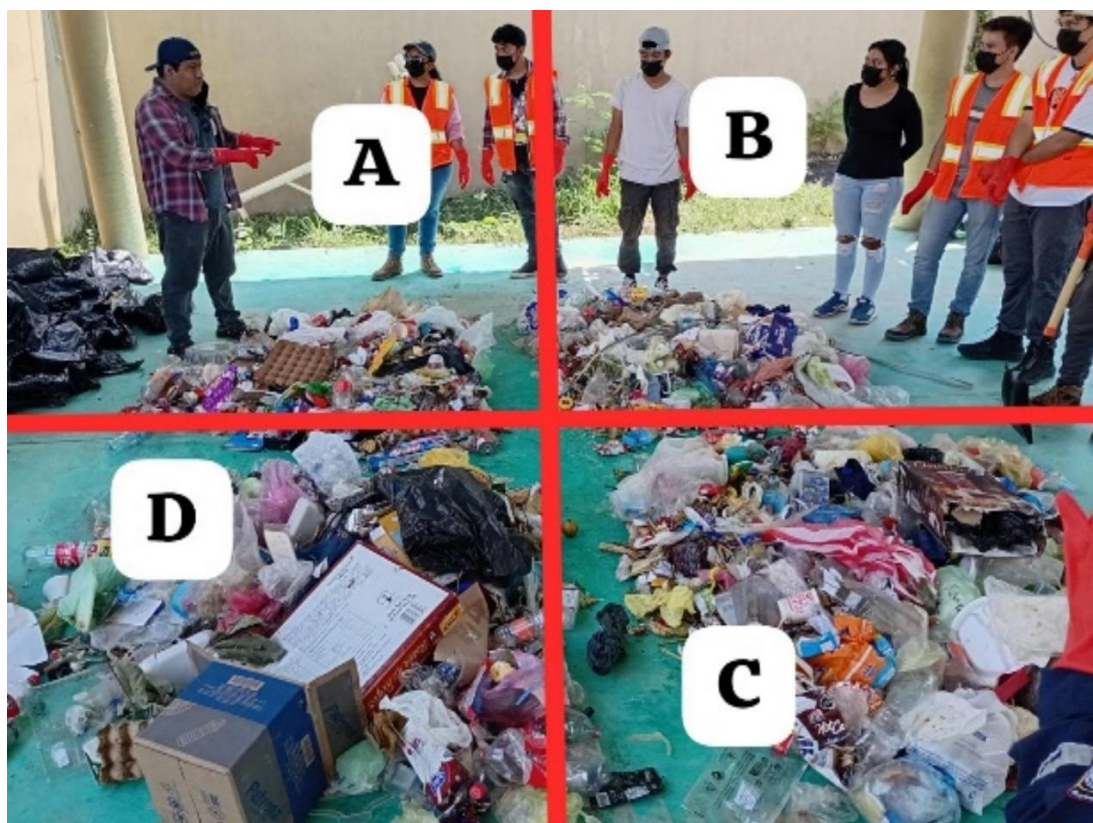
Figura 21 C y D inverso para la determinación de peso volumétrico
