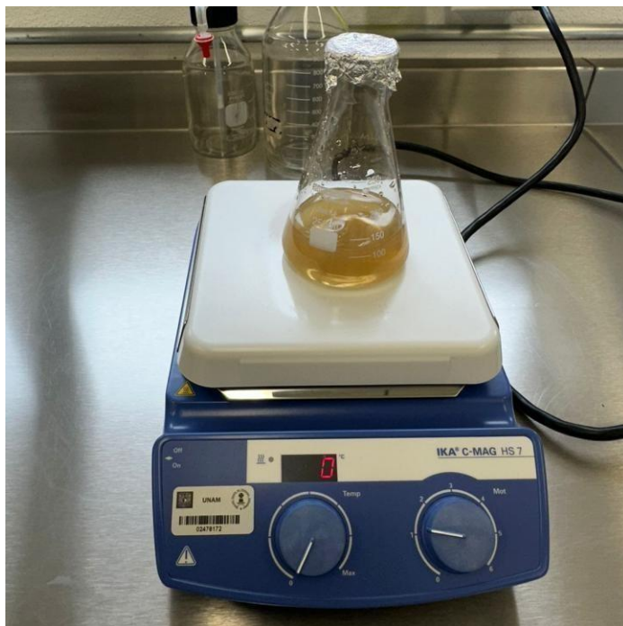
Figura 3. La imagen muestra la solución de sacarosa al 70% lista para el proceso de agitación durante 30 minutos con un agitador magnético.
