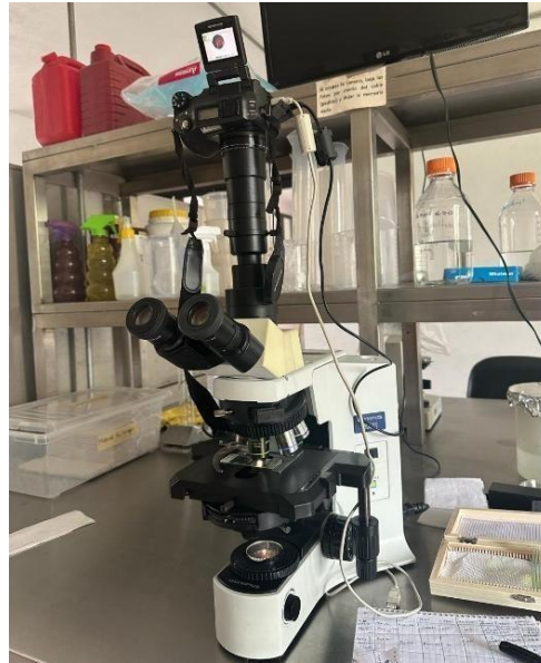
Figura 7. Microscopio óptico OLYMPUS utilizado para la identificación de las esporas, en el cual se tomaron las medidas y fotografías de las esporas
