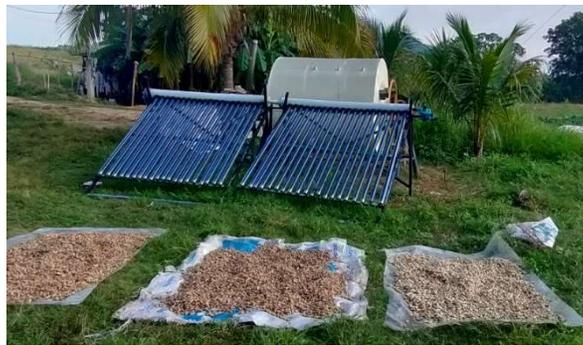
**Figura 5** *Secador solar híbrido rotatorio de colector solar de tubos de vacío – biomasa de flujo forzado para cacahuate.*
