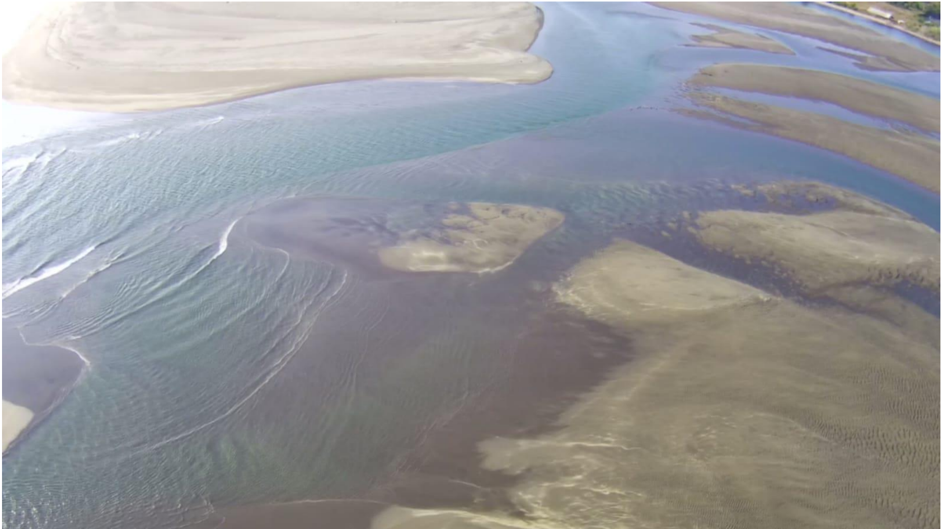
Figura 36. Fotografía aérea de la bocabarra de Boca del cielo que muestra el elevado proceso de sedimentación y una reducción del canal de entrada de agua del Océano (Fotografía tomada con un Dron en Marzo de 2023).
