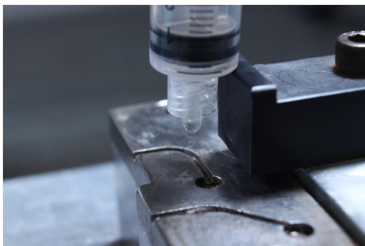
IMAGEN 17. APLICACIÓN DE 0.2 ML DE ACEITE SINTÉTICO EN EL CONDUCTO ARTIFICIAL.
