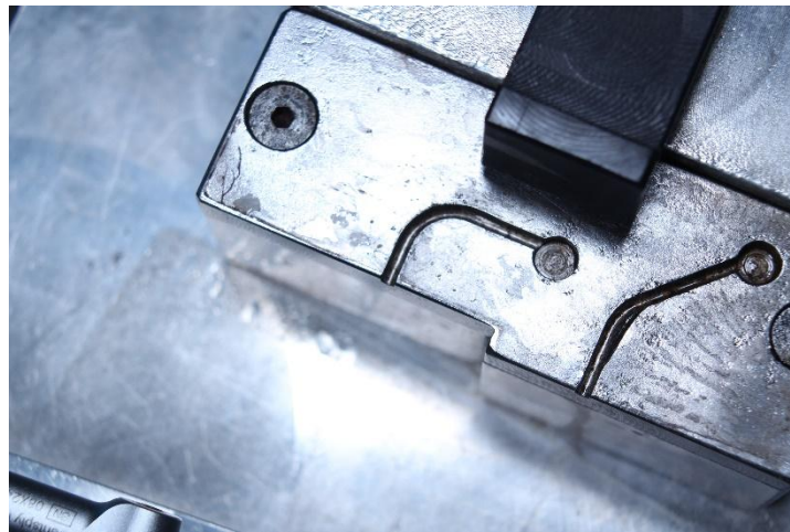
IMAGEN 15. DISPOSITIVO DE ACERO INOXIDABLE PARA PRUEBAS DE FATIGA CÍCLICA
