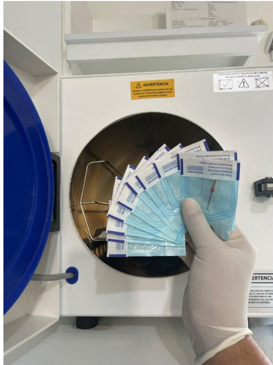
IMAGEN 13. ESTERILIZACIÓN EN AUTOCLAVE A 136 °C.
