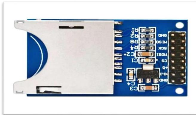
**FIGURA 5.** MODULO LECTOR DE TARJETA SD.
