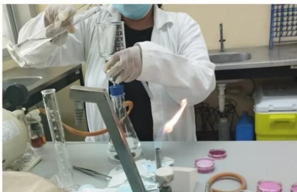
Después de la filtración, la membrana se colocó en el medio selectivo para coliformes totales y fecales, con la ayuda de pinzas estériles, el medio selectivo fue colocado previamente en cajas Petri estériles, con cojín, de 47mm.
