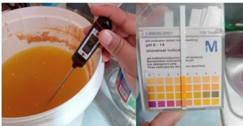
Figura 12. Verificación de la temperatura y el pH en la fermentación diaria
