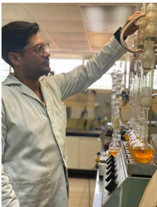
Figura 12. Supervisión del proceso de extracción de grasas.
