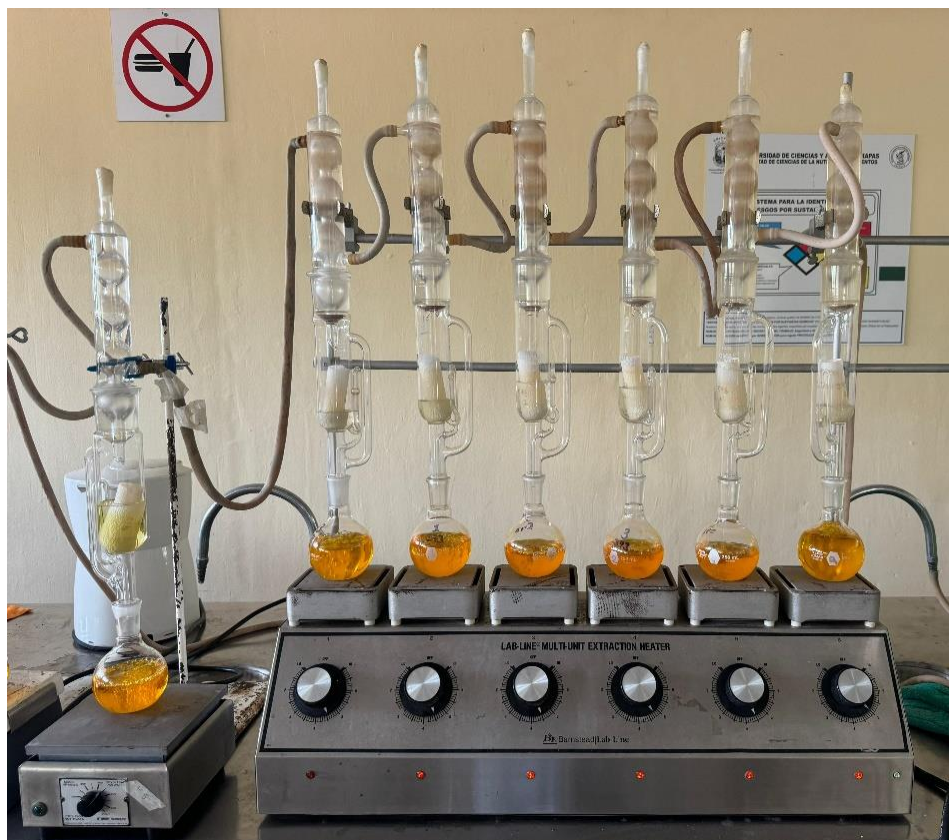
Figura 11. Obtención de grasas en equipo de extracción Soxhlet.
