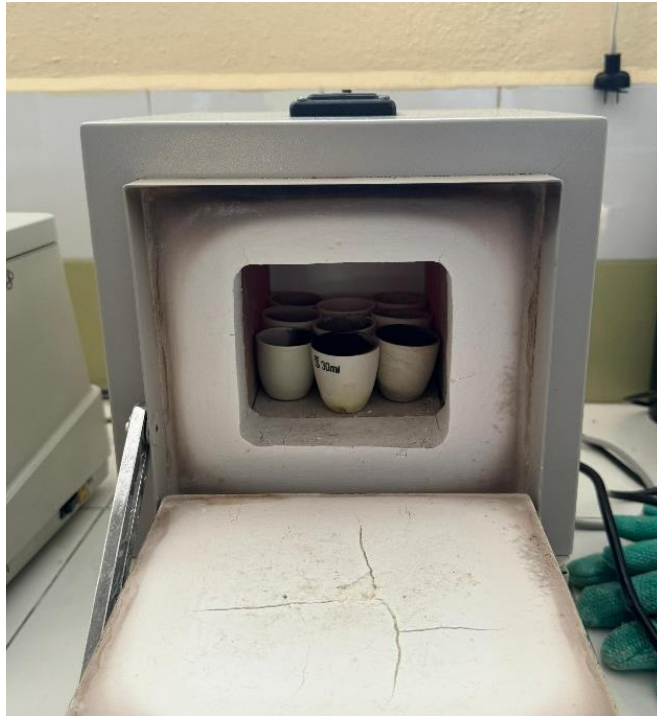
Figura 13. Introducción de crisoles en mufla para la obtención de ceniza.
