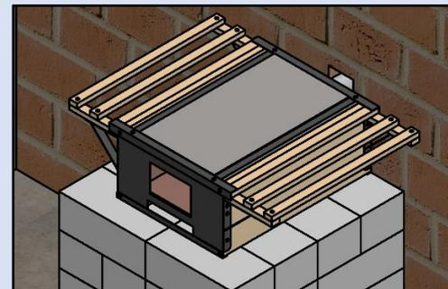
Figura D50 — Coloque la cámara de combustión sobre la base e introduzca la estructura de acople para la chimenea en la abertura del muro.
