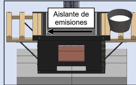
Figura D76 — Selle los espacios entre la cámara de combustión y el comal (G) empleando las pastas sugeridas en la tabla A33.
