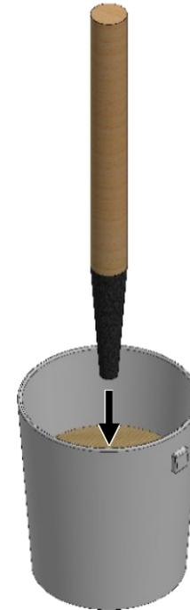
Figura D60 — Al concluir las actividades de cocción retire con cuidado la leña restante de la cámara de combustión y apague las llamas introduciendo el extremo con brasas en un contenedor con arena o grava fina.
