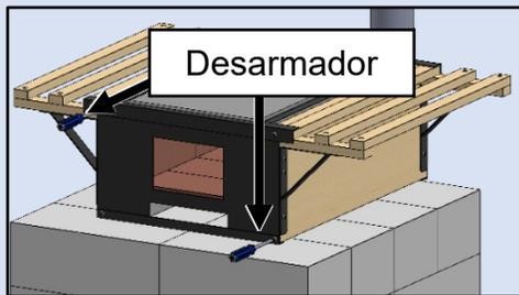
Figura D82 — Coloque los tornillos (N) y las piezas desmontadas (J, H, I y L) en su posición inicial.
