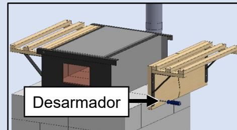
Figura D80 — Retire los tornillos (N) que sujetan las ménsulas (L) a las paredes de madera dañadas (J).
