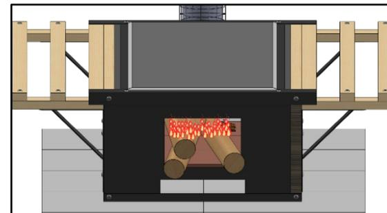
Figura D77 — Inicie la combustión en la estufa para secar y compactar el sello.
