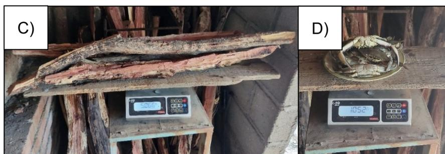
Fig. 4.15 — Medición del: C) consumo de combustible y D) masa de alimentos cocinados.
