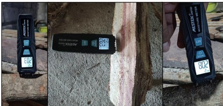
Fig. 4.12 — Mediciones del contenido de humedad de la leña (base seca).
