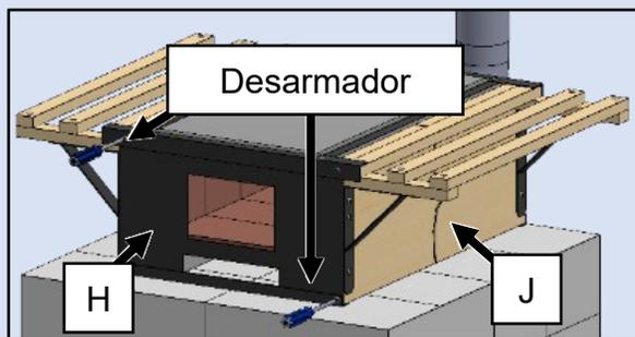
Figura D78 — Retire los tornillos (N) que sujetan los ángulos de acero (M) y las cubiertas (H e I) a las paredes laterales de madera (J).
