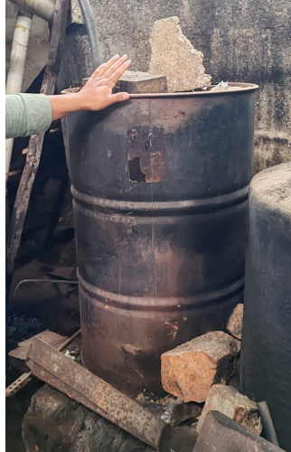
Figura 5. Tambo de metal que se utilizaban antes para calentar el fermento (Maldonado, 2024).
