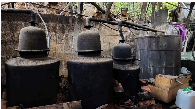
Figura 7. Alambiques para la destilación del pox (Maldonado, 2024).
