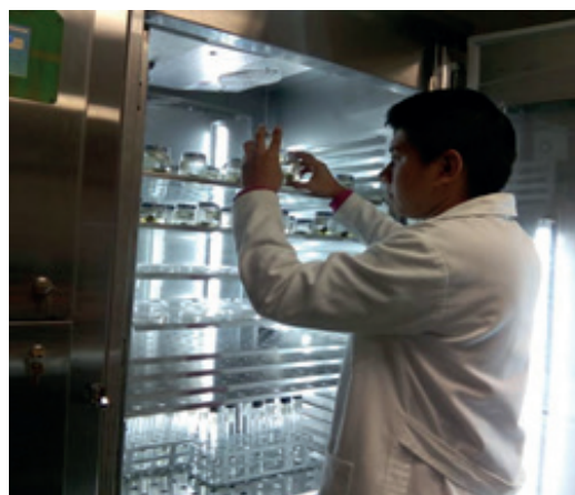
Figura 3. Cámara germinadora para consentir a las semillas controlando los parámetros ambientales, en las que germinarán.
