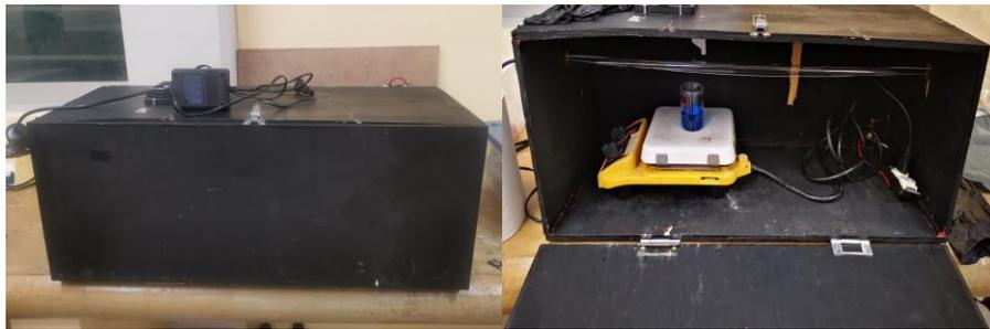
*Figura 17. Reactor para el alcance de la degradación del azul de metileno.*
