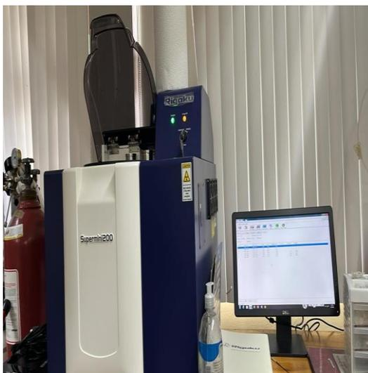
*Figura 16. Espectrofotómetro de Fluorescencia de Rayos X (WD-FRX).*
