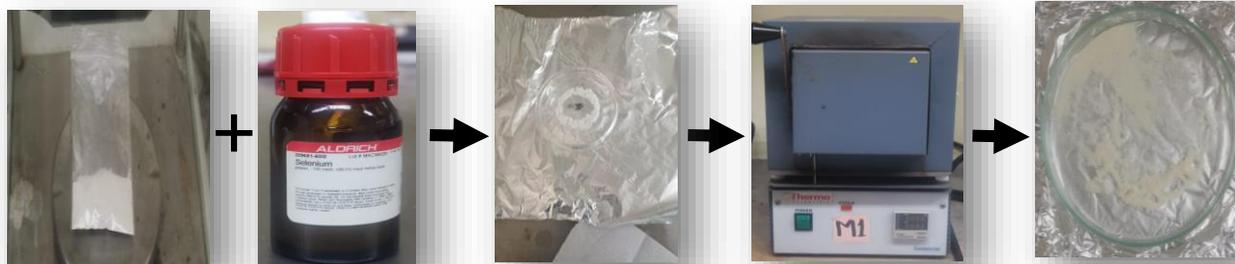
*Figura 12. Selenización del  $\text{TiO}_2$ .*
