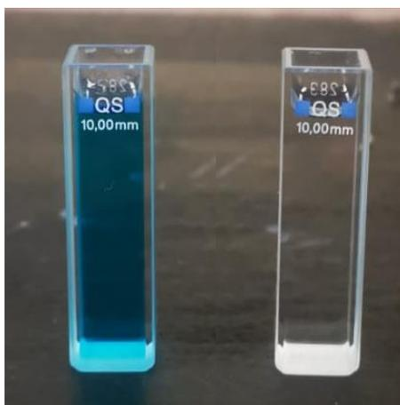
**Figura 29.** Muestra de imagen del colorante azul de metileno sin mineralización a 10 ppm y muestra de agua al haber utilizado el fotocatalizador de  $TiO_2$ -Se 10% 500 °C 30 min.
