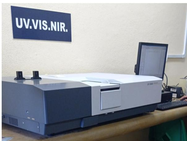
Figura 3. 7. Espectrofotómetro marca Shimadzu modelo 3600 UV-Vis-NIR.
