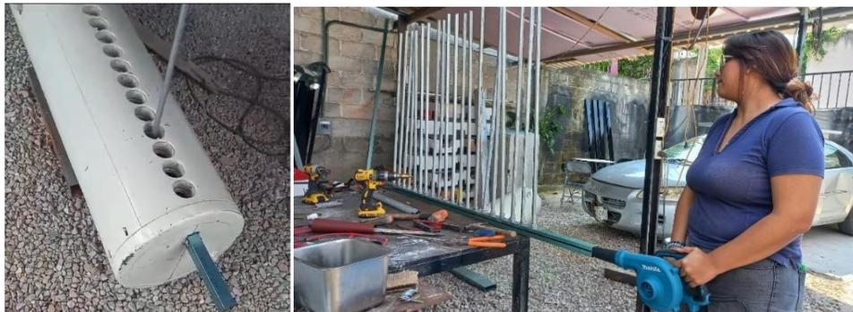
Figuras 38 y 39. Pruebas del peine inyector del aire perforación del termotanque.
