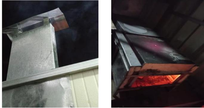
**FIGURAS 22 Y 23 PRUEBAS DE LA CÁMARA DE COMBUSTIÓN**
