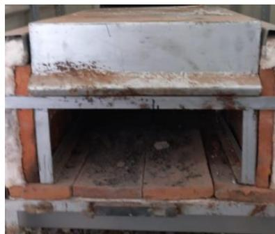
FIGURA 17. ENSAMBLE DE LA CÁMARA DE COMBUSTIÓN.
