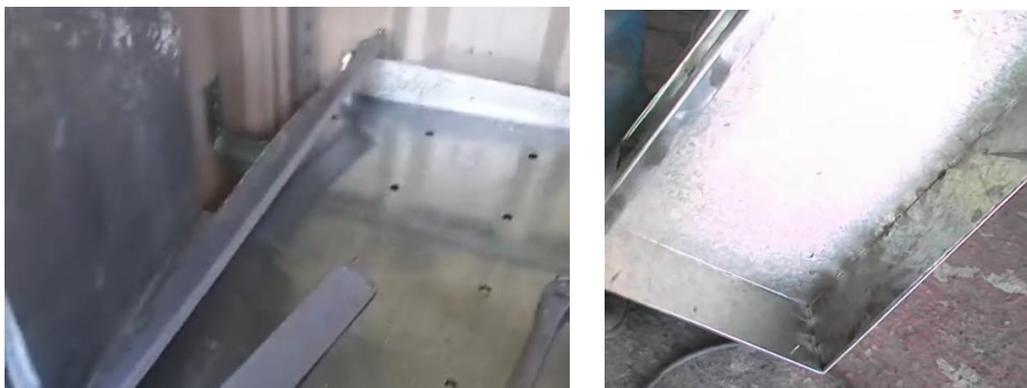
**FIGURAS 25 Y 26. ESTRUCTURA Y ENSAMBLE DEL SOPORTE PARA EL SISTEMA DE ACUMULACIÓN TÉRMICA.**
