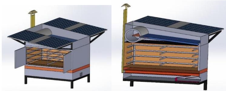
Figuras 2 y 3. Imágenes del diseño del secador bioenergético multipropósito
