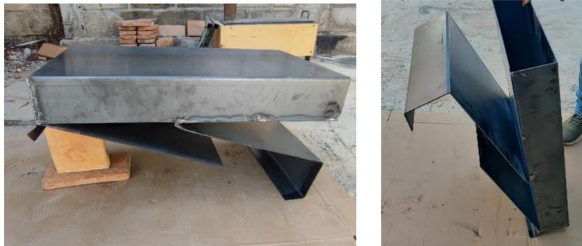
FIGURA 15 Y 16. SISTEMA DE AIRE INTERNO EN CÁMARA DE COMBUSTIÓN.
