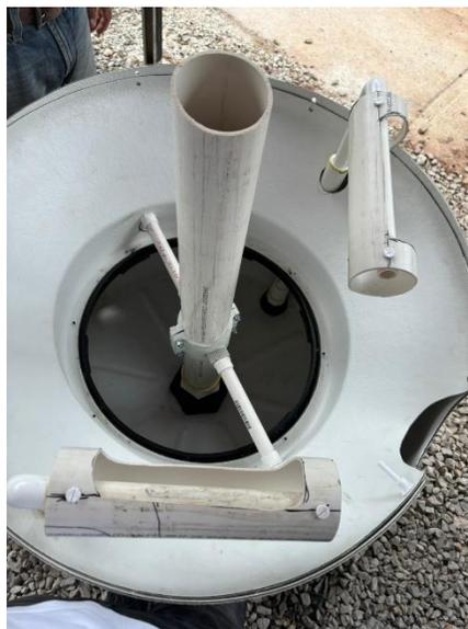
Ilustración 24. Vista previa de los remos y tubería agregada para brindar mejor estabilidad al biodigestor.
