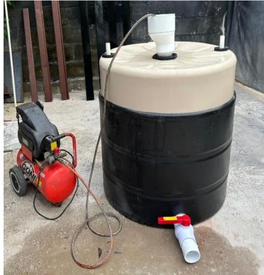
Ilustración 59. Compresor ingresando aire en el biodigestor.
