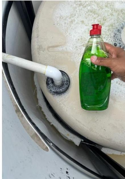
Ilustración 70. Prueba con solución jabonosa para comprobación de fugas de aire.
