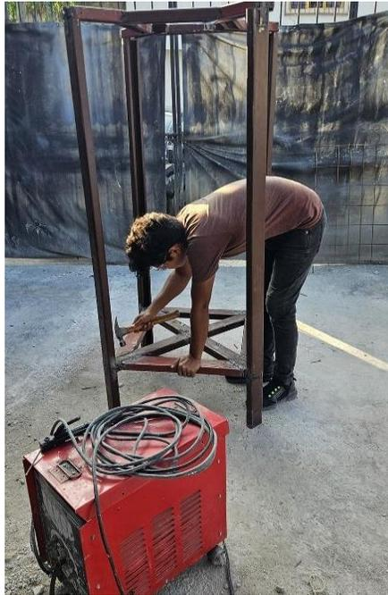
Ilustración 28. Estructura de soporte armada y soldada.
