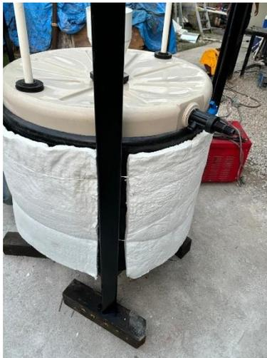
Ilustración 31. Biodigestor recubierto de fibra de vidrio.
