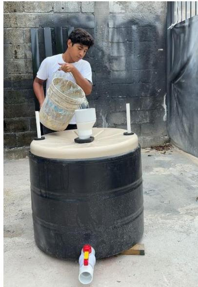
Ilustración 58. Prueba de agua para la verificación de retención de gas y elevación del contenedor.
