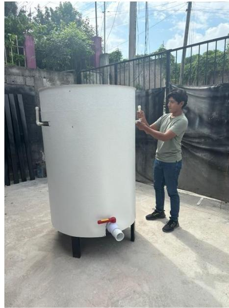
Ilustración 45. Biodigestor casi culminado.
