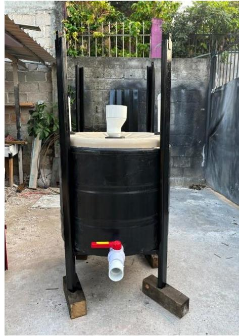
Ilustración 29. Biodigestor colocado dentro de la estructura.
