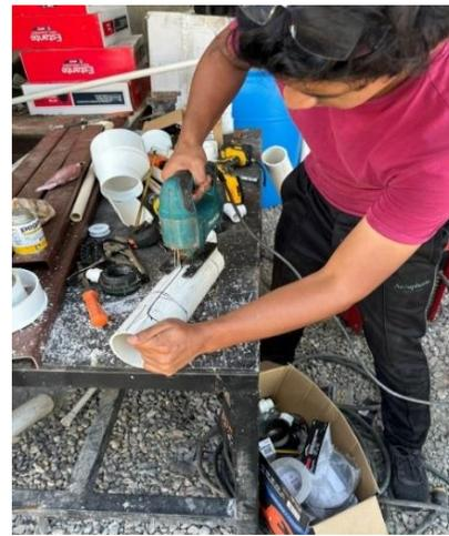
Ilustración 21. Realización de los cortes para la realización de los remos del sistema de remoción.
