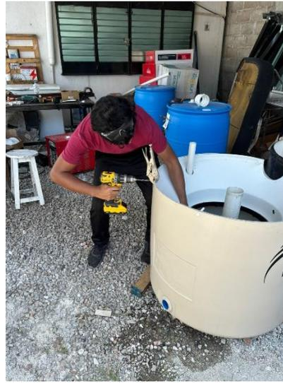
Ilustración 18. Perforación en los contenedores para la introducción de tornillos de plástico.
