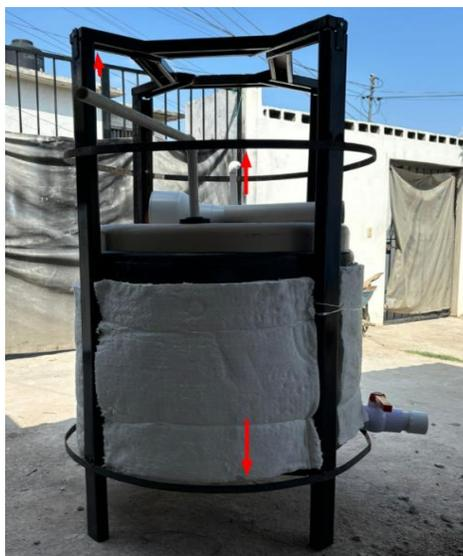
Ilustración 35. Posiciones en las que se fijaron las soleras en forma circular.
