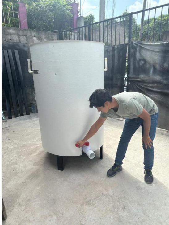
Ilustración 68. Revisión del correcto funcionamiento de las llaves.
