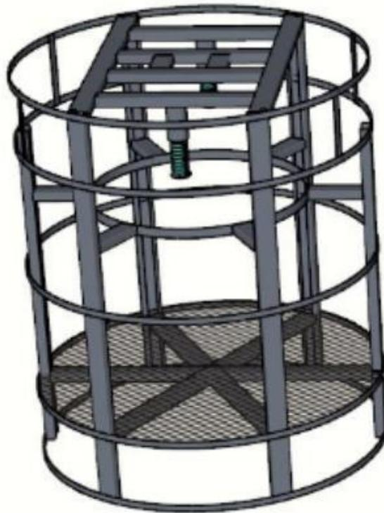
Ilustración 7. Estructura de soporte.
