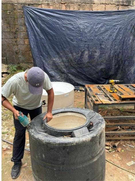
Ilustración 11. Recorte de la parte superior del segundo recipiente que se encontrará en la parte inferior.
