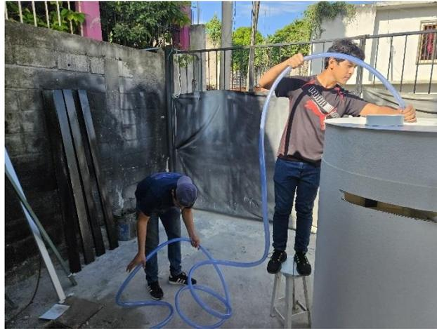
Ilustración 76. Prueba hidráulica para comprobación del correcto funcionamiento del biodigestor.
