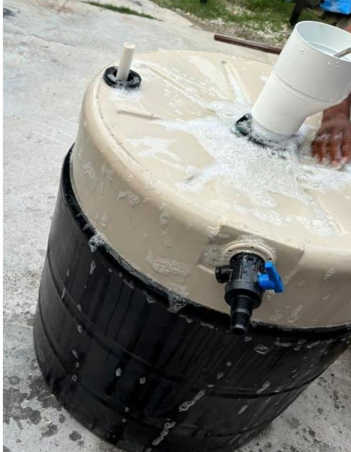
Ilustración 57. Prueba de fuga de aire con solución jabonosa.
