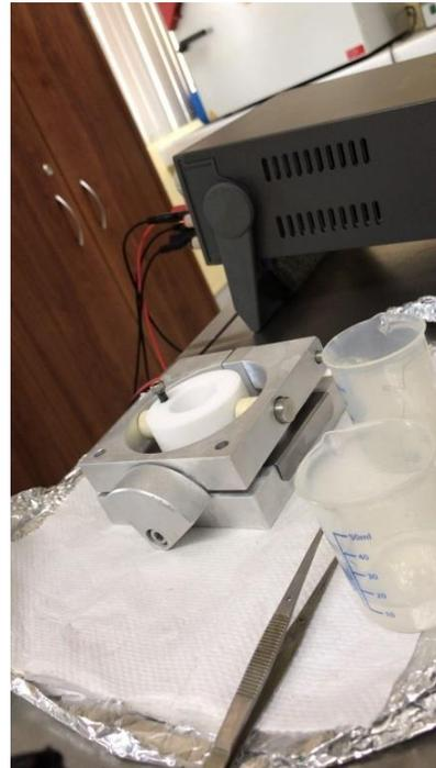
*Figura 3.4 Fotografías del proceso de fabricación del silicio poroso. a) Prueba de sellado con etanol, b) Celda conectada durante el proceso de fabricación de las muestras SP/Ga<sub>2</sub>O<sub>3</sub>.*
