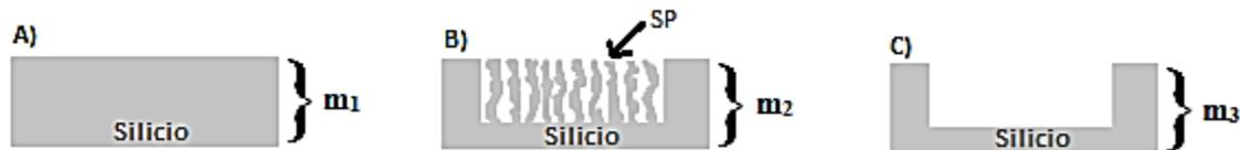
*Figura 2.4 Esquema de las masas de los pasos para obtener porosidad, obtenido de “Simulación y obtención de estructuras periódicas y cuasiperiódicas fabricadas con silicio poroso”, Colin Becerril, 2022.*
