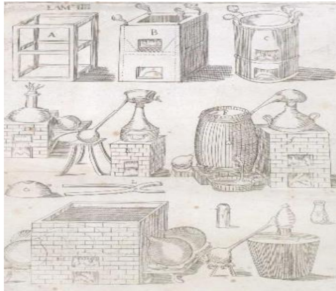
Figura 3: Hornos, vasos y alambiques utilizados en el arte de la botica (Carlos y David, 2022)
