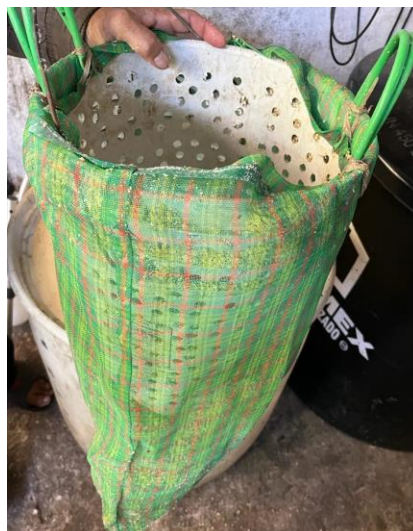
Figura 20: Filtro prensa utilizado para eliminar sedimentos (Propia, 2023)
