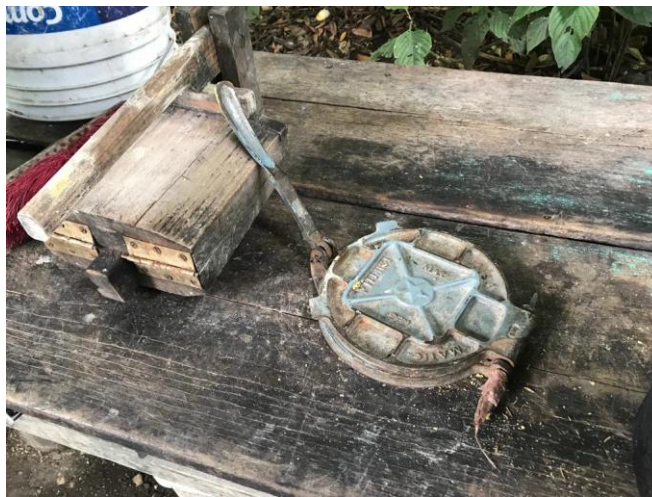
Figura 12. Herramienta para la elaboración de tortillas, prensa metálica y de madera (Figuroa y García, 2023)
