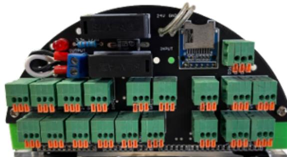
**Figura 4.7.** Construcción del módulo de entradas y salidas.
