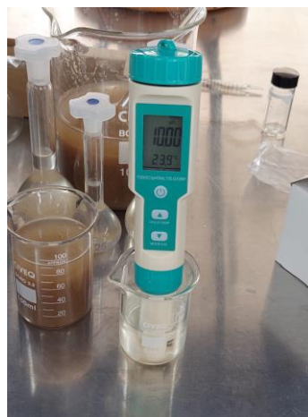
Figura 16. pH metro digital portátil para la determinación de sólidos totales disueltos, conductivímetro, salinidad, temperatura, potencial redox, pH.
