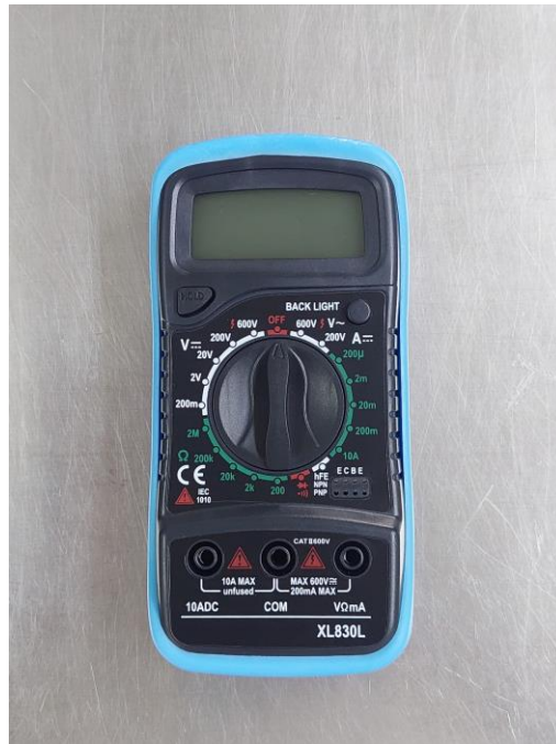
Figura 28. Multímetro digital para la medición de voltaje y corriente.
