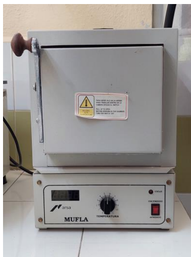
Figura 25. Mufla utilizada para la determinación de cenizas.
