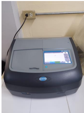
Figura 18. Espectrofotómetro para la lectura de los valores de DQO.
