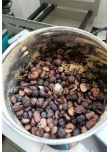
**Figura 6.** Triturado de semillas de mojú en molino eléctrico.
