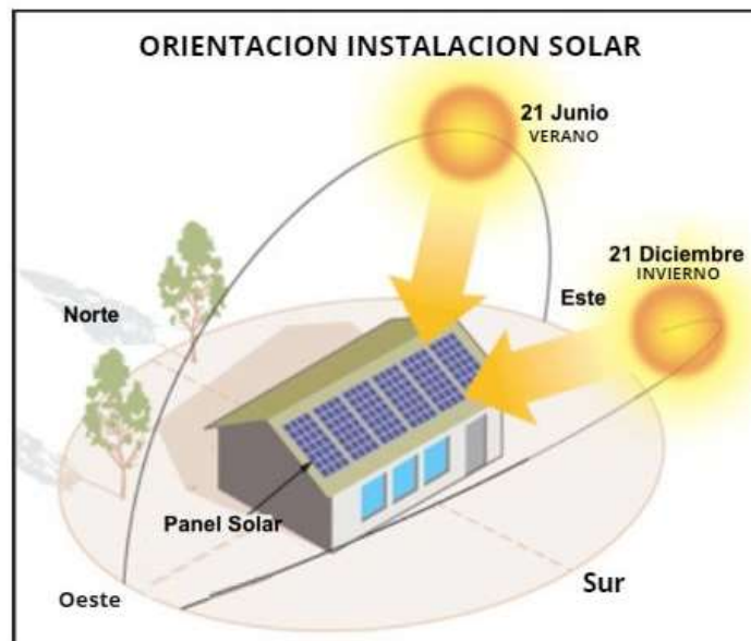
Figura 20 Orientación de una instalación solar.
