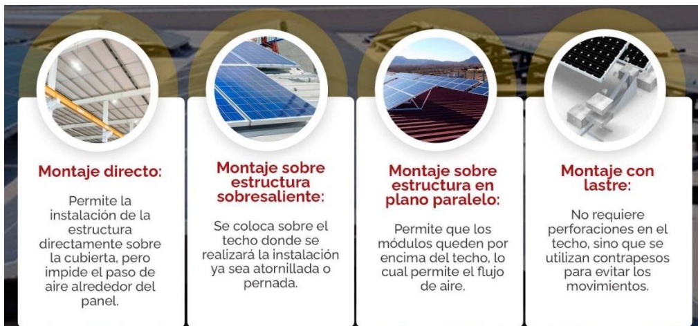
Figura 30. Estructuras sobre techo.
