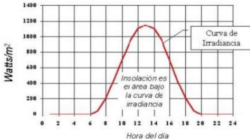
Figura 9. Curva que muestra la diferencia entre irradiancia solar e irradiación solar (insolación).
