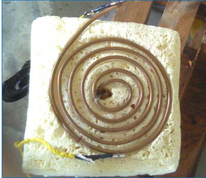
**Ilustración 30.** Ajuste de aislante térmico al serpentín de cobre.
