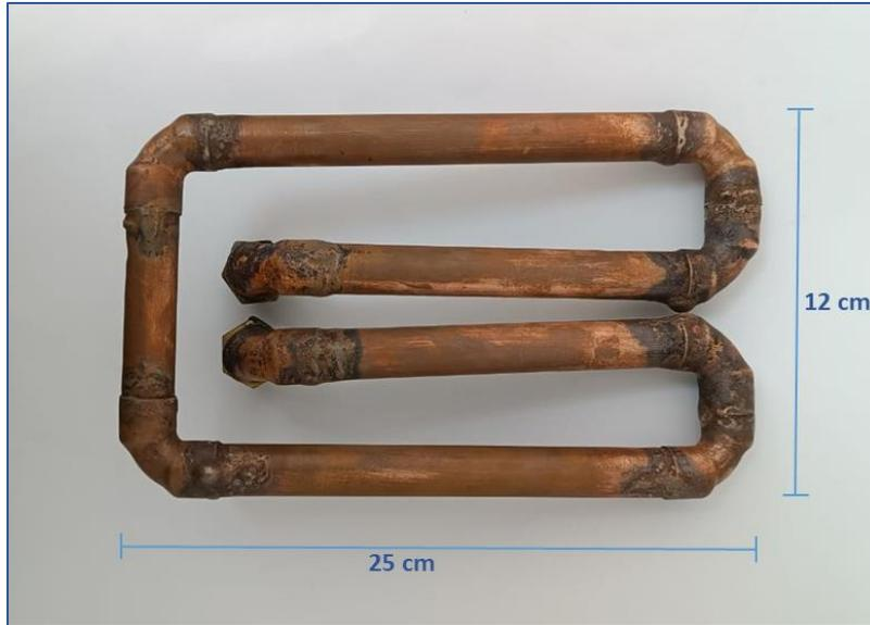
**Ilustración 24.** Serpentín de cobre moldeado en forma rectangular.
