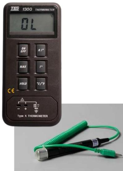
**Ilustración 31.** Termómetro Digital de Contacto/Inmersión
