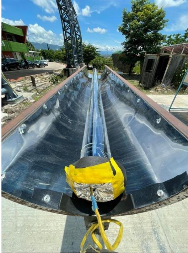
**Ilustración 14.** Estufa solar cilíndrico-parabólica (Toledo et al, 2022).
