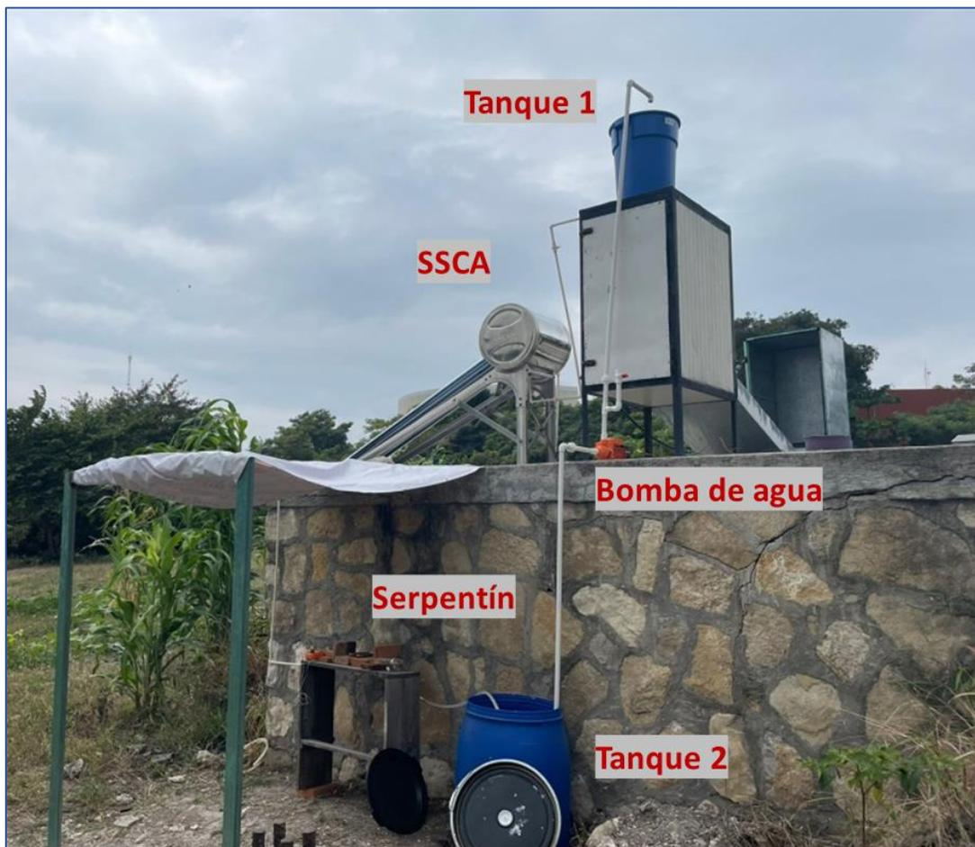
**Ilustración 26.** Prototipo experimental de la estufa solar indirecta con circulación forzada.
