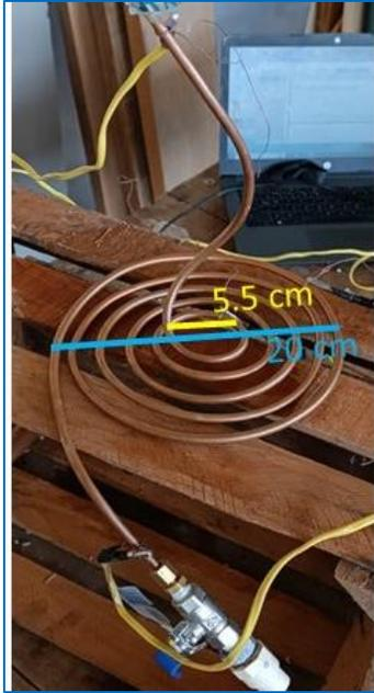
**Ilustración 28.** Construcción de la espiral de cobre en forma de espiral.
