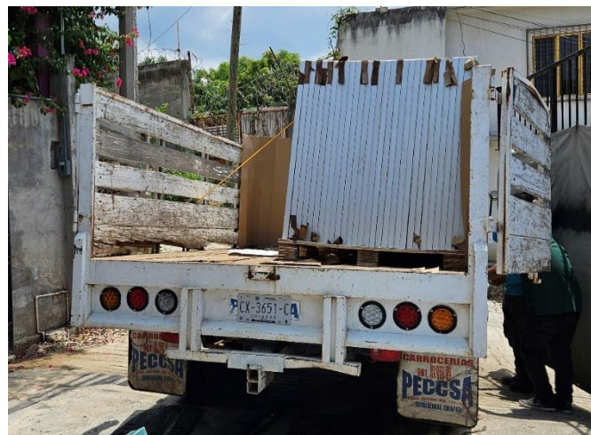
Imagen 28. Paneles fotovoltaicos asegurados para ser transportados. Imagen por: Mario Benitez.
