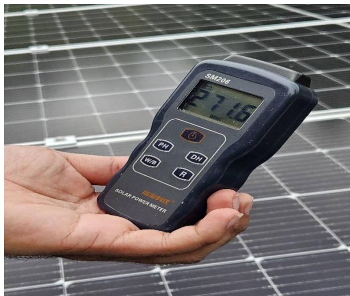
Imagen 63. Piranómetro Energy Radiation Meters SM2006 en operación. Imagen por: Mario Benitez.
