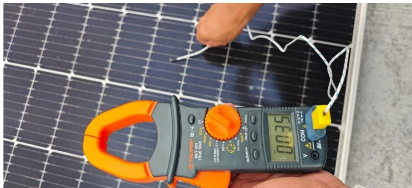
Imagen 65. Temperatura del panel fotovoltaico. Imagen por: Mario Benitez.
